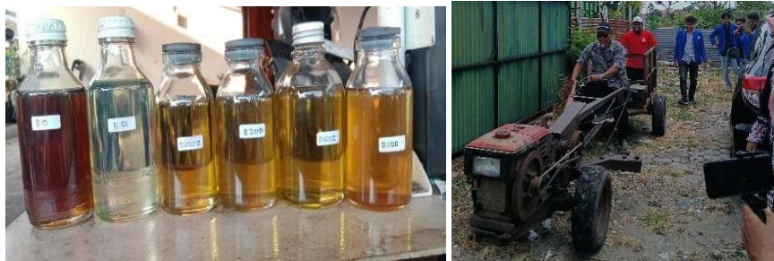
Gambar 5. Uji coba mesin tractor menggunakan BBM dari Sampah plastik
